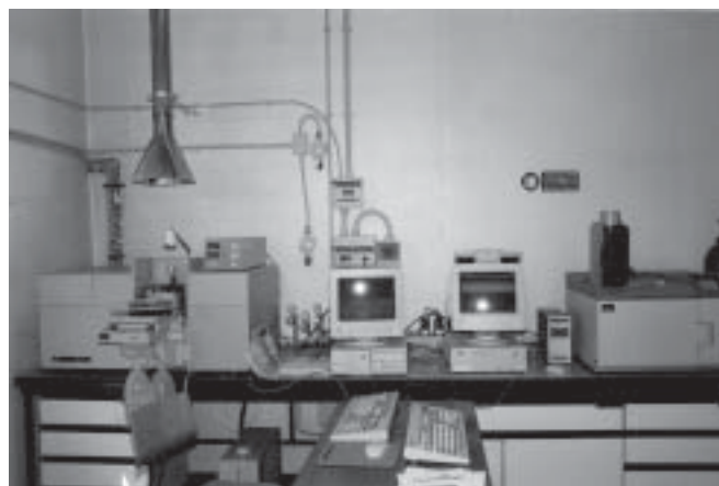
Particolare di uno dei laboratori di ricerca del C.N.R.: spettrofotometro in assorbimento atomico e gascromatografo.
